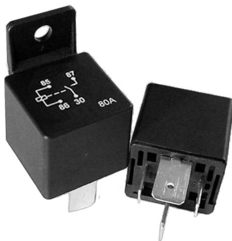
Bild A: Ett konventionellt bilrelä med standardiserade kontakterminaler
